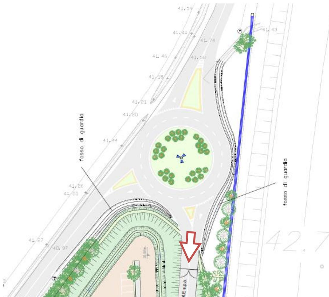
Figura 1: nuova intersezione a rotatoria su via Vittorio Veneto per l'accesso degli spettatori ed operatori all'area P.U.A.
